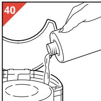
Vul het waterreservoir met **gewone azijn** in plaats van water, en plaats geen filterzakje met gemalen koffie (fig. 40).
