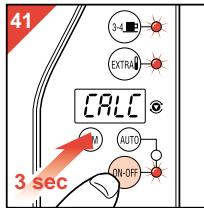
Se a lâmpada indicadora “ON/OFF” começar a cintilar e a palavra “CALC” alternar com a indicação da hora correcta (fig. 39), isto significa que a máquina necessita ser descalcificada.
