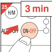
Si acaban de hacer una jarra de café y quieren hacer otra inmediatamente después, apaguen primero la cafetera (fig. 25) y dejen que se enfrie durante tres minutos. Después ya pueden volver a llenar de agua el depósito y repetir el proceso.
