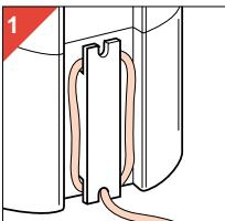
Überschüssiges Netzkabel können Sie auf der Rückseite des Geräts unterbringen (Abb. 1).
