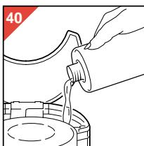
Füllen Sie den Wasserbehälter mit **Haushaltsessig**, und setzen Sie den Filter nicht auf.
