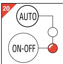
Quando a máquina de fazer café for automaticamente ligada, a lâmpada indicadora encarnada ficará iluminada e a lâmpada amarela apaga-se.
