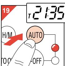
Aprieten el botón **AUTO** si quieren que la cafetera se active automáticamente al llegar la hora prefijada (dentro de un plazo de 24 horas) (fig. 19). El piloto amarillo correspondiente se iluminará.
