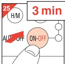
Als u meteen opnieuw koffie wilt zetten, schakel dan de koffiezetter uit (fig. 25) en laat het apparaat tenminste drie minuten afkoelen. Daarna kunt u het waterreservoir opnieuw vullen.
