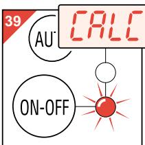
Si empieza a parpadear el piloto "ON/OFF" y la palabra "CALC" alterna con la hora del reloj (fig. 39), el aparato necesita descalcificación.
