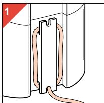
O excesso de cabo de alimentação pode ser arrumado na parte detrás da máquina de café (fig. 1)
