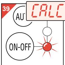
Wanneer het controle-lampje "ON/OFF" gaat knipperen en het woord "CALC" afwisselend met de normale kloktijd in het venster zichtbaar wordt (fig. 39), moet uw apparaat ontkalkt worden.
