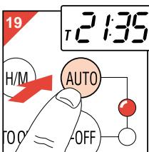
Druk op toets **AUTO** als u wilt dat de koffiezetter zichzelf (binnen 24 uur) automatisch inschakelt op de door u ingestelde tijd (fig. 19). Het bijbehorende gele controlelempje "auto" gaat branden.
