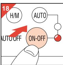
Carregue na tecla **ON/OFF** se quiser que a máquina de fazer café comece a funcionar imediatamente (ou seja, sem utilizar o temporizador) (fig. 18). A lâmpada indicadora encarnada fica iluminada.
