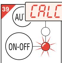
Quando la spia “**ON/OFF**” inizia a lampeggiare e la parola “**Calc**” si alterna all’orario (fig. 39) significa che occorre decalcificare l’apparecchio.
