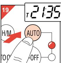
Carregue na tecla **AUTO** se quiser que a máquina de fazer café fique automaticamente ligada à hora marcada (no espaço de 24 horas) (fig. 19). A lâmpada indicadora amarela fica iluminada.
