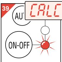
Votre appareil a besoin d'être détartré lorsque le voyant "ON/OFF" se met à clignoter et que le mot "CALC" alterne avec l'heure (fig.39).
