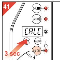
Houd de aan/uit (On/Off) schakelaar bij het inschakelen drie seconden ingedrukt. De drie rode controlelampjes gaan dan knipperen (fig. 41).
