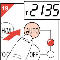
Appuyez sur le bouton **AUTO** si vous désirez que la mise en marche de l'appareil se fasse automatiquement à une heure pré-sélectionnée (dans les 24 heures) (fig. 19).
