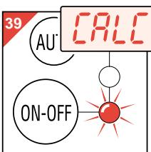
Wenn die Kontrolllampe "ON/OFF" aufleuchtet und das Wort "CALC" erscheint (Abb. 39), muß das Gerät entkalkt werden.
